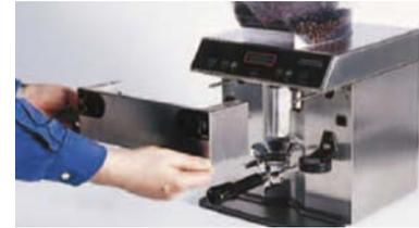
4.2.3 Die Verriegelungsschieber (Pos.10) herausziehen und die Abdeckung (Pos. 4) vom Unterteil gerade nach oben abheben.
