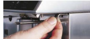
4.2.4 Entfernen Sie die Transportsicherung. Kontrollieren Sie Anschlussstecker der Mahlwerke auf richtigen und festen Sitz. Heben Sie die Transportsicherung auf, denn nur mit der Sicherung kann die Mühle ohne eine Beschädigung zu erleiden verschickt oder transportiert werden. Stecken Sie die Zwischentrichter auf die Mahlwerke bis zum Anschlag fest auf.
