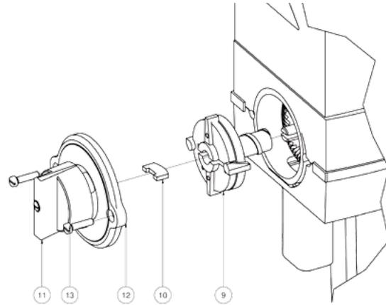
4. Ziehen Sie den Vorbrecher (9) von der Motorwelle ab. Benutzen Sie dazu eine Abziehvorrichtung (Artikel Nr. 4041).
